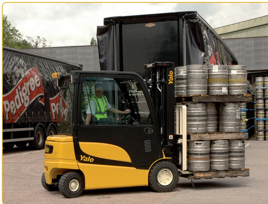
regolabile continuamente per una ampiezza di 26°. Durante le svolte, la velocità dei motori di trazione viene regolata continuamente indipendentemente dal controllo della trazione assicurando un funzionamento dolce. Yale VL presenta un nuovo modernissimo assale sterzante personalizzato, che ha una migliore articolazione delle ruote direttrici consentendo la svolta in spazi più ristretti rispetto ad un assale sterzante convenzionale a 4 ruote.
