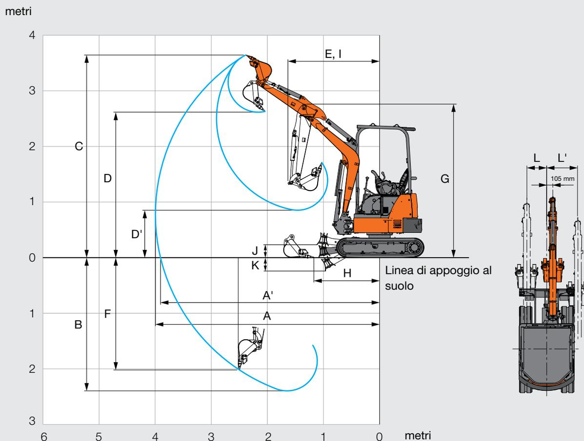
L'illustrazione mostra il modello equipaggiato con braccio di penetrazione da 1,13 m, benna da 0,044 m<sup>3</sup> e pattini di gomma da 230 mm.
