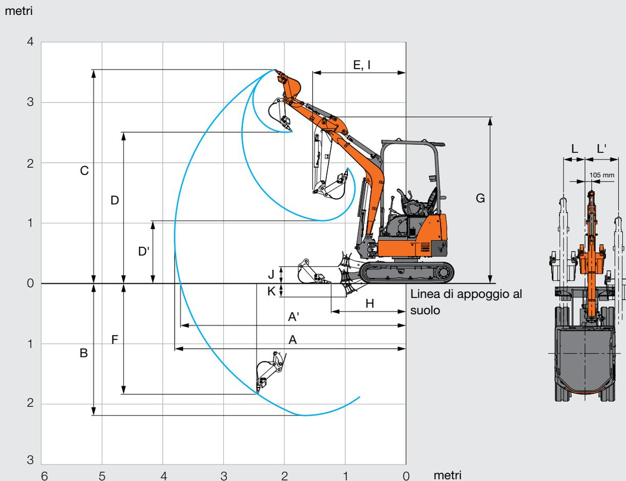
L'illustrazione mostra il modello equipaggiato con braccio di penetrazione da 0,93 m, benna da 0,044 m<sup>3</sup> e pattini di gomma da 230 mm.
