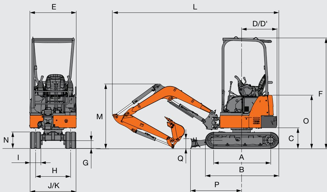
L'illustrazione mostra il modello equipaggiato con braccio di penetrazione da 1,13 m, benna da 0,044 m<sup>3</sup> e pattini di gomma da 230 mm.
