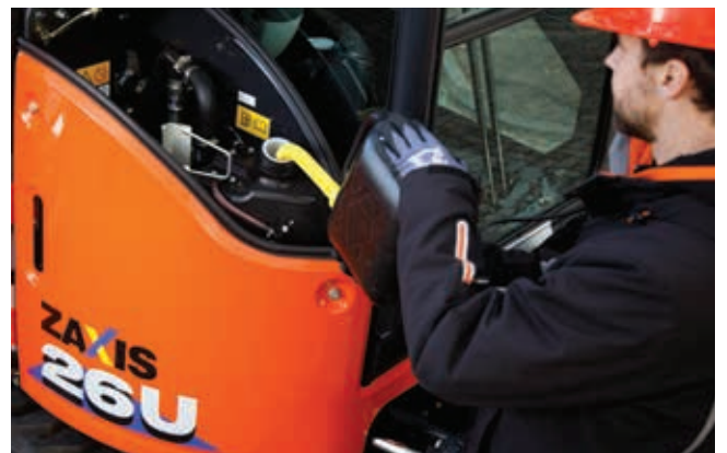
Spazio adeguato intorno all'apertura del serbatoio del carburante, per facilitare il rifornimento.
