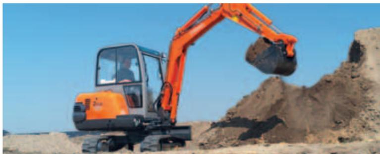
Hitachi ha sviluppato le nuove serie di escavatori ZAXIS 30, ZAXIS 35, ZAXIS 40 e ZAXIS 50 per applicazioni in servizio gravose. Questi escavatori compatti possono essere utilizzati in uno spazio ristretto e, grazie al braccio basculante, permettono di eseguire i lavori con precisione e flessibilità.
