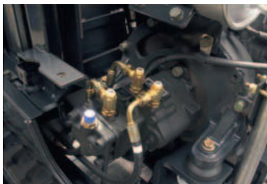
Anche le leve di traslazione degli escavatori sono ora a controllo idraulico. Ciò rende le operazioni più facili e precise. Per trasferimenti su lunghe distanze è possibile utilizzare i pedali.
