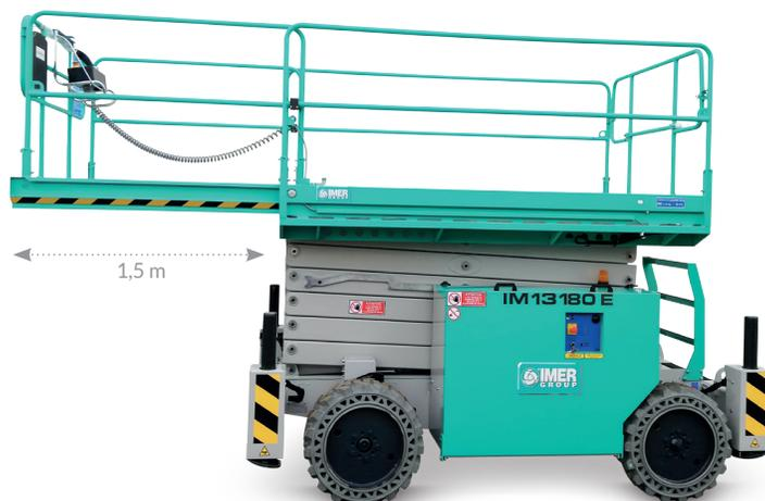
Estensione manuale della piattaforma di 1,5 m per una lunghezza complessiva di 4,2 m
